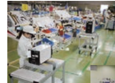
みんなのドライポンプ活動：スピードを重視した1台流しライン
