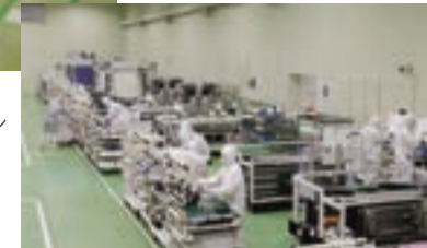
Mゼロチャレンジ活動：部品をジャストインタイムで作業者の手元に供給
